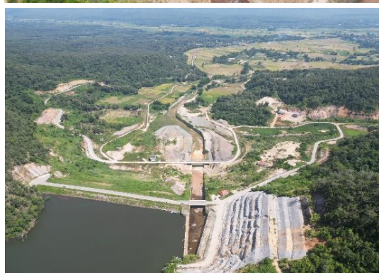
รูปที่ 1.5-1 งานทำนบดินห้วยงานและอาคารประกอบ
